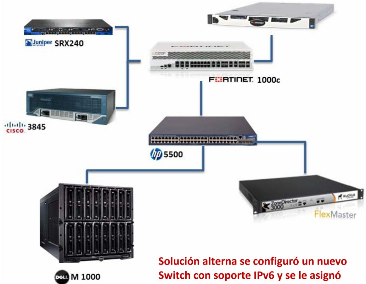
**Solución alterna se configuró un nuevo Switch con soporte IPv6 y se le asignó algunas funciones de capa 3**
